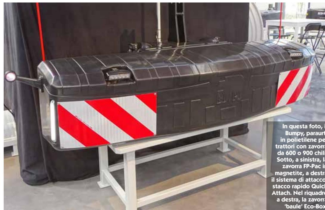
In questa foto, il Bumpy, paraurti in polietilene per trattori con zavorra da 600 o 900 chili. Sotto, a sinistra, la zavorra FP-Pac in magnetite, a destra il sistema di attacco/stacco rapido Quick Attach. Nel riquadro a destra, la zavorra 'baule' Eco-Box.
